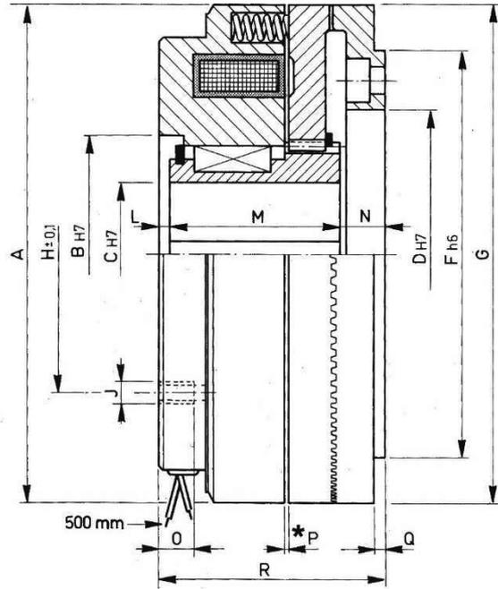
\* P = Regolazione traferro / Air gap adjustment (pag. 51)
