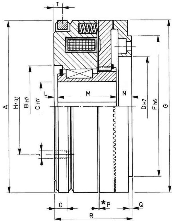
\* P = Regolazione traferro / Air gap adjustment (pag. 51)
